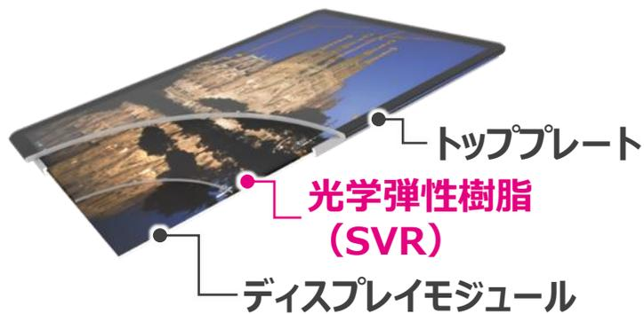
スマートフォン・タブレット・ノートPC等のディスプレイ内部にあるエアギャップを埋め、光の屈折・反射を抑える紫外線硬化型の弾性樹脂です
